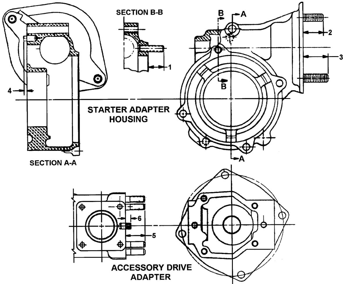
**FIGURE 11-1. STARTER ADAPTER STUD SETTING HEIGHTS**
