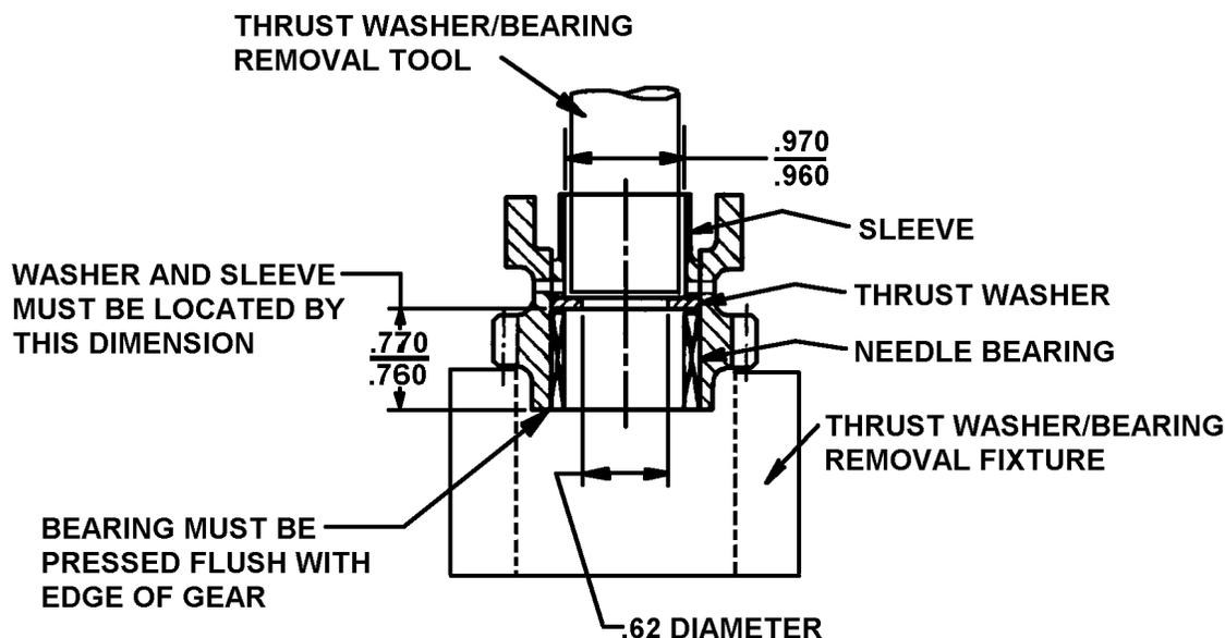
FIGURE 8-2. MAGNETO DRIVE GEAR ASSEMBLY
