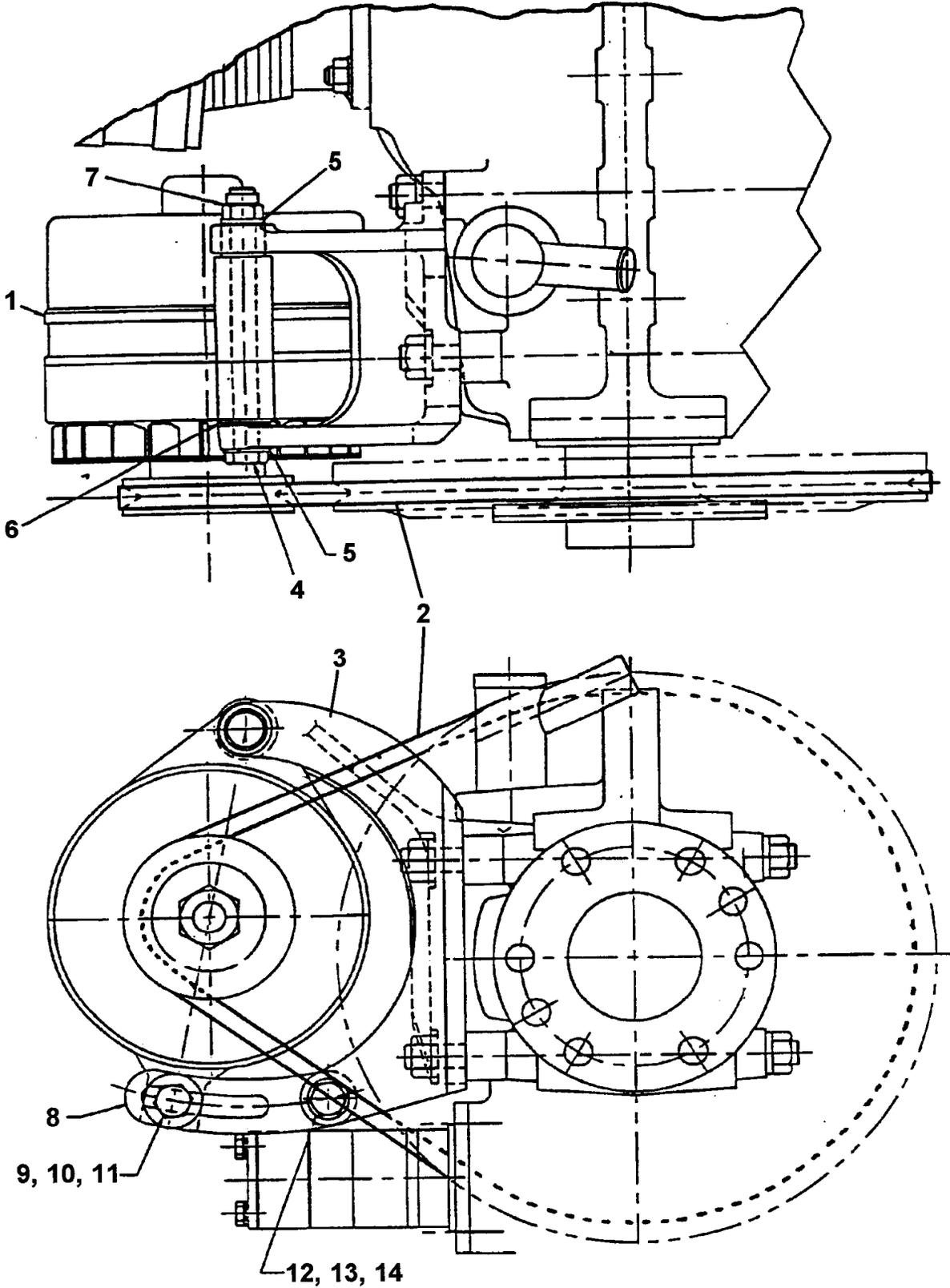
FIGURE 6-6. BELT DRIVEN ALTERNATOR ASSEMBLY
