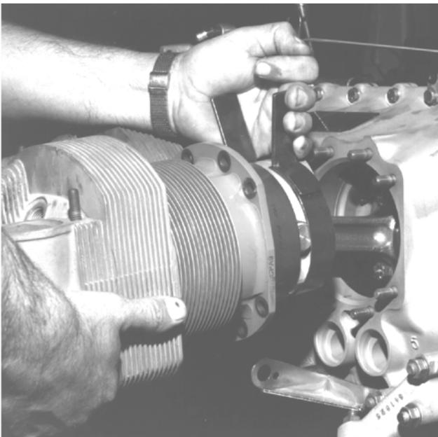
**FIGURE 19-7. INSTALLING NUMBER FIVE CYLINDER**
