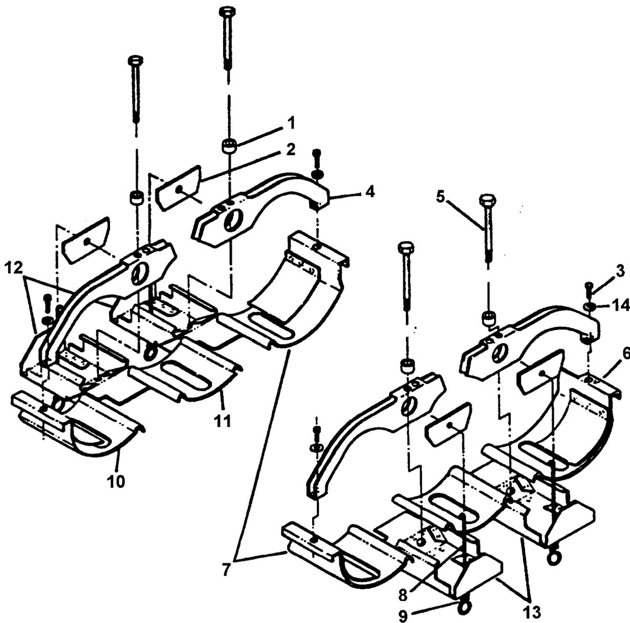
FIGURE 6-14. CYLINDER BAFFLE ASSEMBLY
