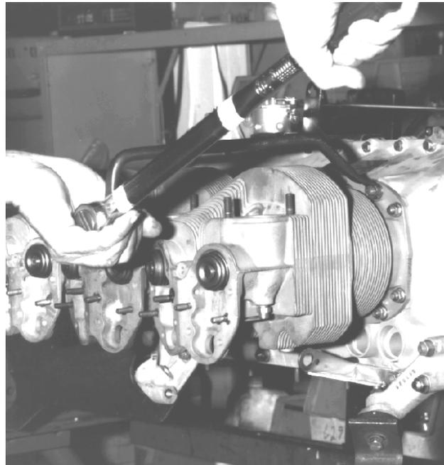
**FIGURE 19-8. TORQUING CYLINDER BASE NUT**
