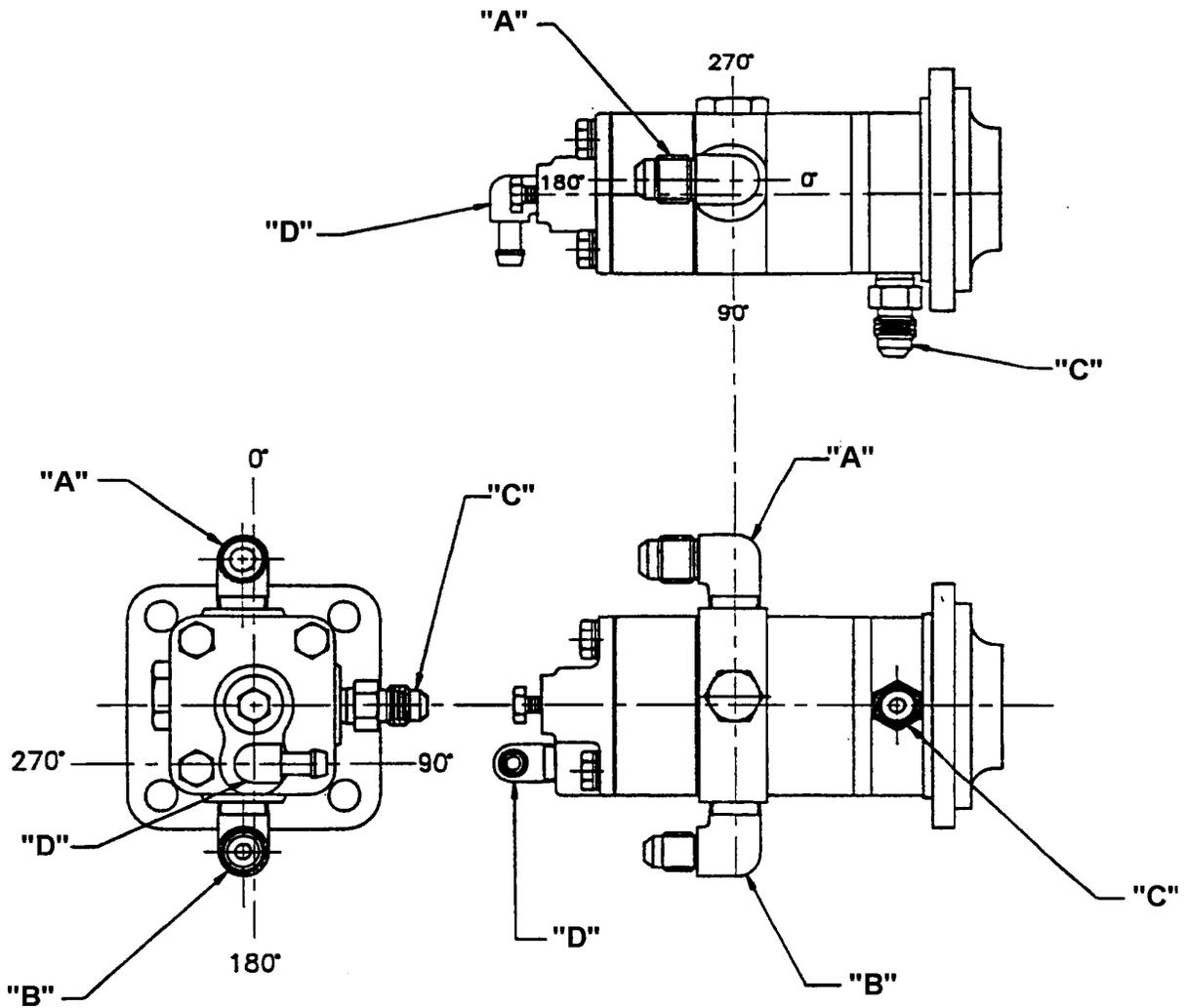
**FIGURE 9-2. FUEL PUMP FITTING LOCATIONS**
