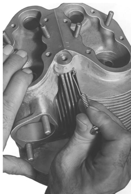
**FIGURE 16-18. SECURING BAFFLE**
