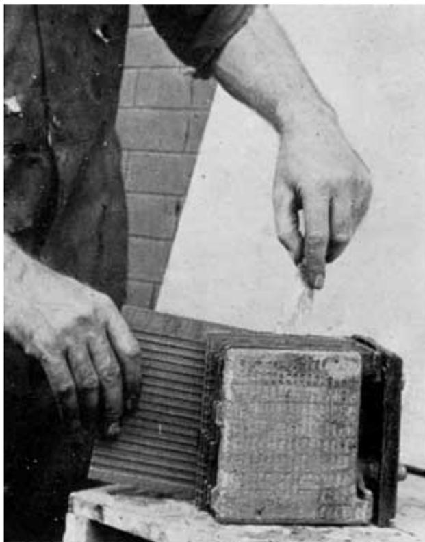
Fig. 225. Inserting Separators
