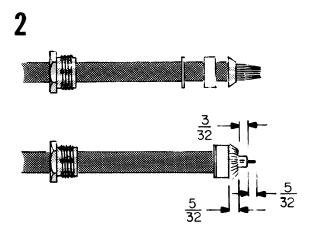
TAPER BRAID OVER DIELECTRIC AND SLIP CABLE NUT, WASHER(WHEN FURNISHED) AND V-GROOVE GASKET OVER CABLE. POSITION BRAID CLAMP WITH SHOULDER TIGHT AGAINST OUTER JACKET. FOLD BRAID BACK OVER BRAID CLAMP.
