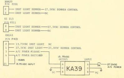
17. POWER GROUND FROM KX145,KMA20,& KX170A/B MUST BE GROUNDED AT THE SAME POINT ON AIRFRAME.
